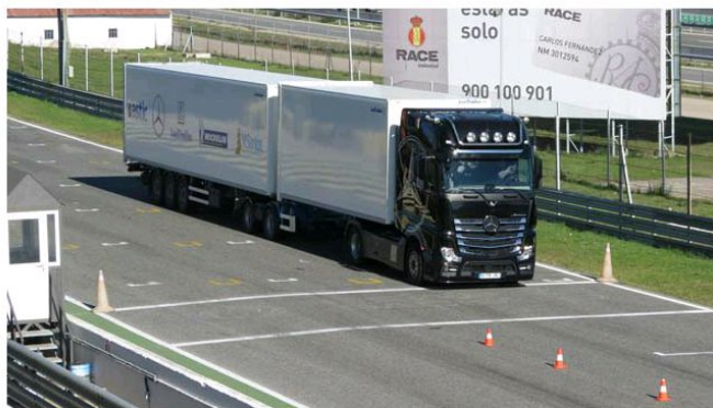
La configuración B Double consta de dos semis con dos quintas ruedas y es muy usada en Australia.
