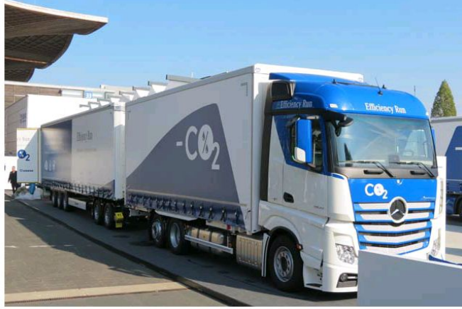
El camión remolcador 6X2 más un dolly que permite manejar el semi como un remolque es más maniobrable.
