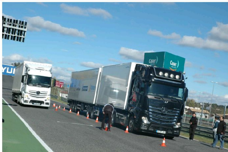
La distancia de frenado de un megacamión con 60 Tn. frente a un trailer con 40 Tn., incluyendo todos los dispositivos de seguridad y frenado de última generación, son 20 m. según la prueba realizada por M. Santos en el Circuito del Jarama.
