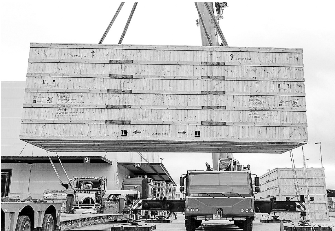
Embalaje de dos extractores metálicos especiales. TM2, empresa de embalaje industrial, trincaje y logística, embala dos extractores metálicos especiales de 50 toneladas cada uno para Vidmar Group, con destino a una nueva línea de cemento ubicada en Colombia. En la imagen, instantánea del proceso de carga de los dos embalajes.
